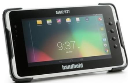
Самый легкий (650 г) защищенный (IP65) планшет серии Algiz с предустановленной ОС Android 6.0 имеет массу коммуникационных возможностей (LTE, Wi-Fi, Bluetooth, NFC). Опционально доступны встроенный лазерный сканер двумерных штрихкодов и устройство обмена RFID с двумя SAM-слотами. Встроенный навигационный приемник совместим с ГЛОНАСС и GPS. 7-дюймовый сенсорный экран поддерживает multi-touch.
